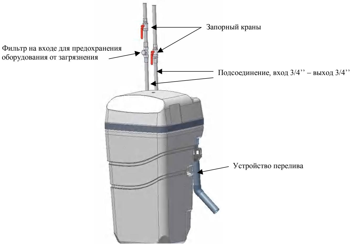
Рекомендуется устанавливать запорные краны как на входе, так и на выходе из установки, чтобы облегчить техническое обслуживание. Также рекомендуется устанавливать фильтр на входе подачи воды, чтобы избежать загрязнения оборудования.
