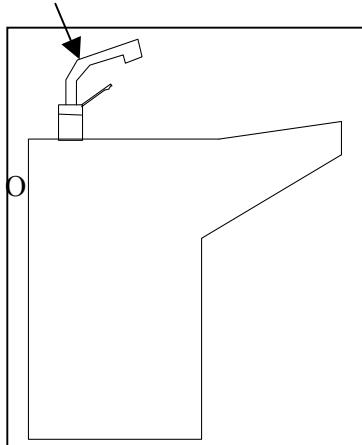
Во время заполнения стенки бака могут деформироваться под тяжестью вод, однако такая деформация не представляет опасности для установки
