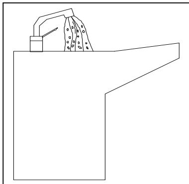
Подождите, пока воздух полностью будет вытеснен из установки водой, затем закройте водоразборный кран.
