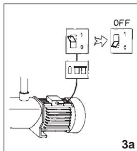
В качестве дополнительной защиты против поражения током, устанавливается дифференциальный выключатель высокой чувствительности (УЗО) с током утечки  $I_v=30\text{mA}$
